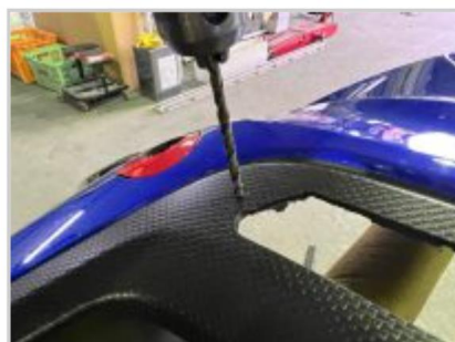
19.ドリルでまず3mmの下穴をあけてから5mmの穴をあけます。この際、左右の位置決めがしやすいように左右楕円形に穴をあけます。
