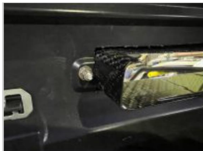
26.表のダクト位置が決まってから付属のM7のセルフナットをバンパー裏側から締め込んで固定します。
