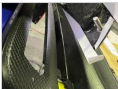
18.画像のようにペイントにて穴の位置決めのためマーキングします。
