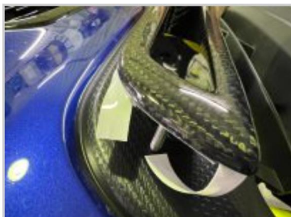
15.左右の取付ボルトがあたるまで入ればOKです。
