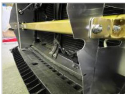
36.この状態になればラジエターダクトを装着した状態でバンパーを固定できます。
