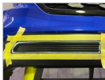
8.ペイントラインの外側をマスキングテープで養生します。
