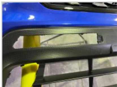
13.ダクトの裏ガイドを何度か仮合わせして入るまで開口の穴を少しづつ削っていきます。
