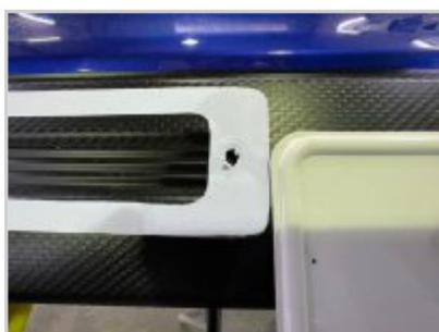
5.ナンバープレートの固定ボルト2本を仮固定の状態にしてナンバープレートをガタの分左側にめいっぱいよせます。
