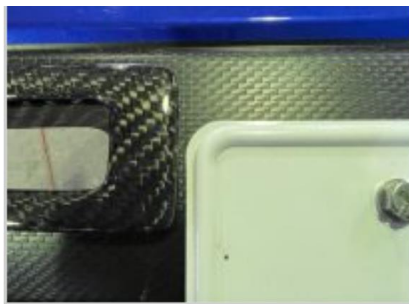
24.位置が決まったら両面テープをはがしてダクトを固定します。ナンバープレートをセンターの位置で固定した場合のクリアランスイメージです。
