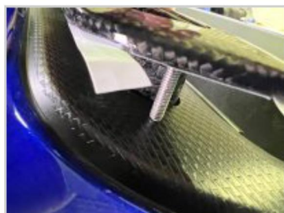
17.左右取付ボルトの先にペイントして再度バンパーにあてます。
