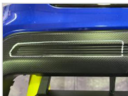
7.型紙の位置が決まったらマスキングテープにて仮止めて開口部の内側のラインにケガキ線をペイントします。
