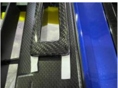
21.右側のイメージです。取付穴は大きい方が位置決めの自由度が上がりますが7mm位までにしてください。裏固定用のワッシャーがかかりにくくなります。
