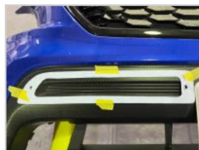
6.その状態のナンバープレートに型紙の右側を画像のように合わせるイメージです。
