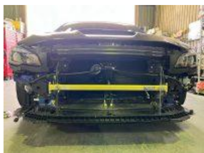
1.純正ビームを外してレイル製フレームトップバーを装着します。
