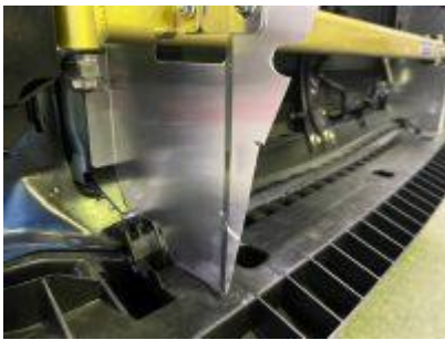
16.その箇所を金切りばさみ等で カットします。
