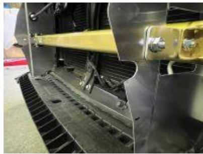
14.ブレーキダクトを装着した バンパーを軽く合わせます。
