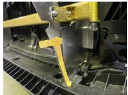
15.干渉しそうな箇所に印を いれてマスキングいたします。
