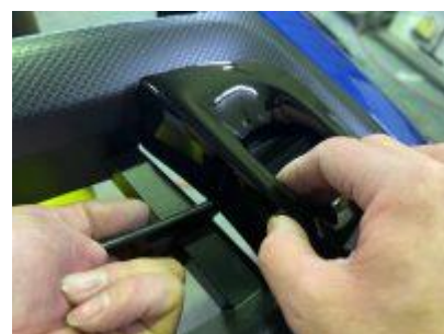
3.バンパーを外して仮合わせします。
